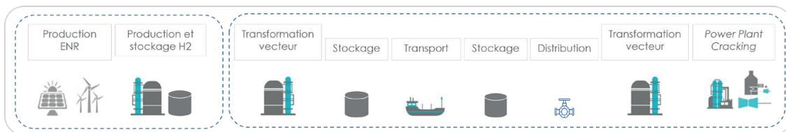
**Figure 1. Ensemble des étapes d'une chaîne de transport d'hydrogène**
